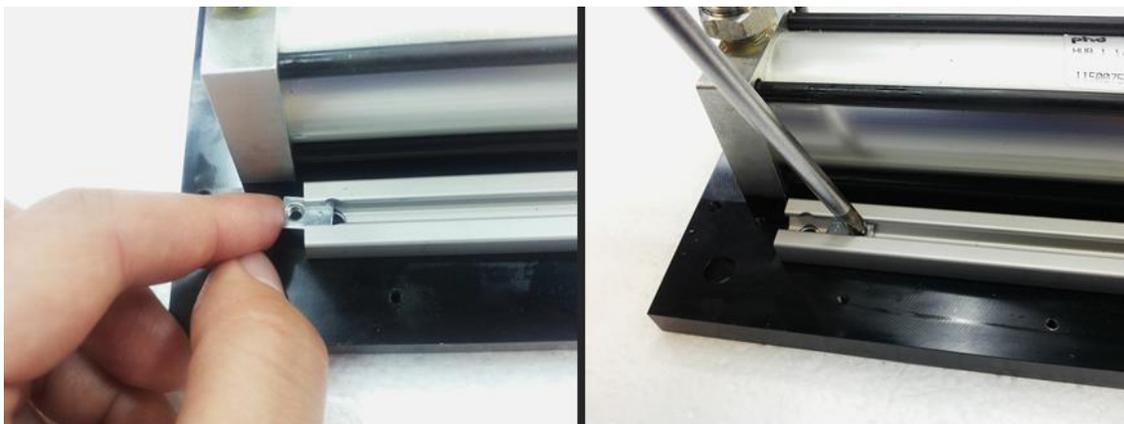
1. Pase el tornillo M4 a través del orificio en la carcasa del sensor (negra), y atorníllelo en la tuerca M4 en la ranura. Posicione el sensor como desee (el sensor blanco hacia el cilindro), y apriete el tornillo.
