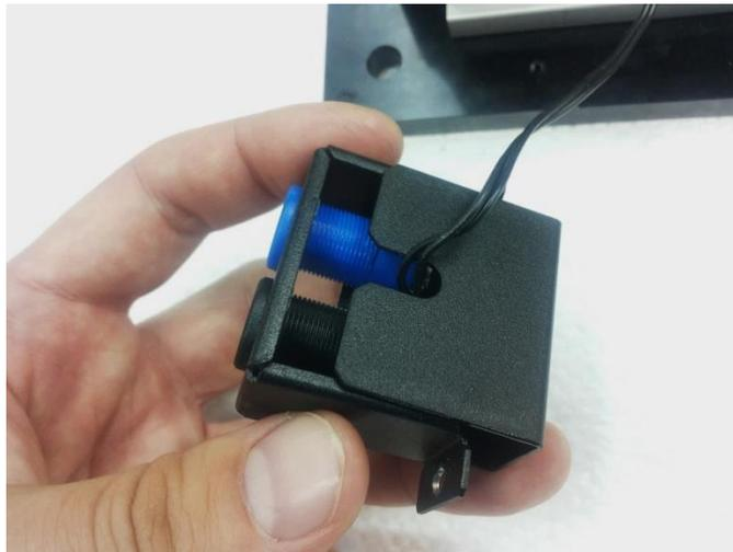
3. Utilizando dos tornillos Phillips, fije el soporte a la placa de montaje del cilindro.
