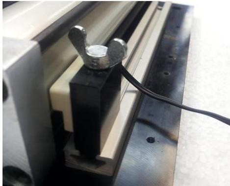
2. Coloque la cubierta sobre el soporte de los conectores de los sensores.
