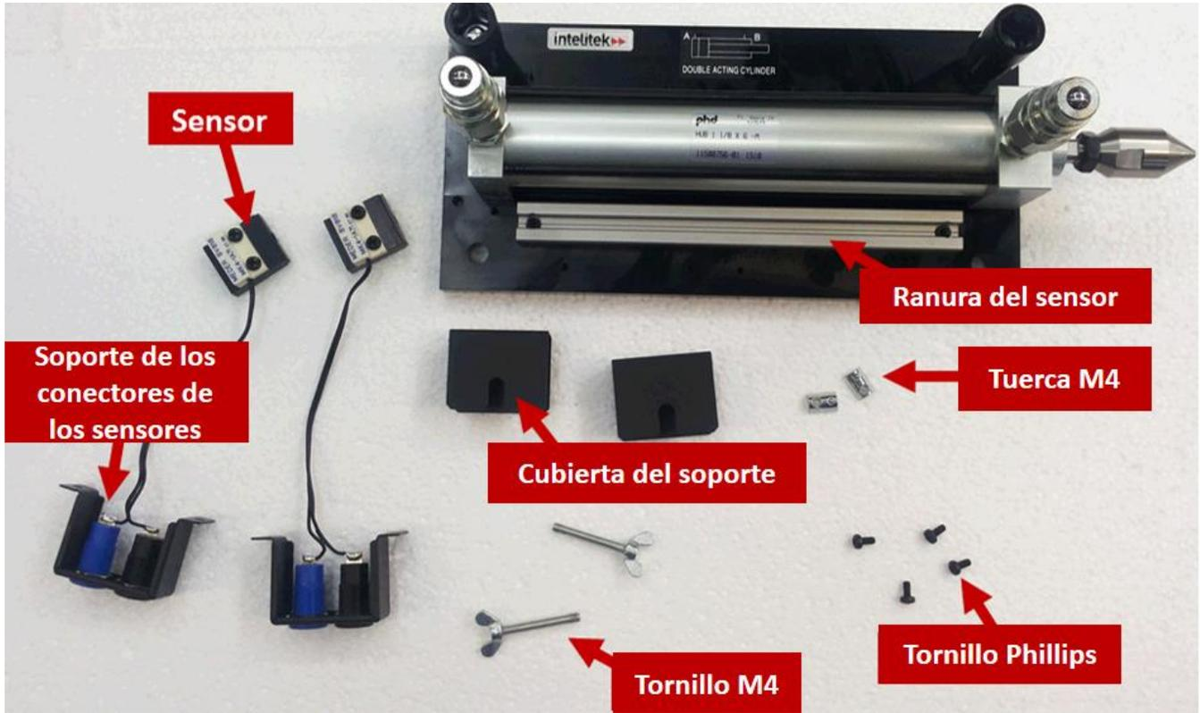
1. Inserte la tuerca M4 en la ranura del sensor a lo largo del cilindro. Puede utilizar un atornillador Phillips para insertar o posicionar la tuerca.
